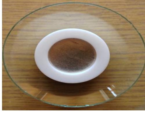
Şekil.5: Kapak ve manyetik bardan oluşan taşıyıcı sistem.
